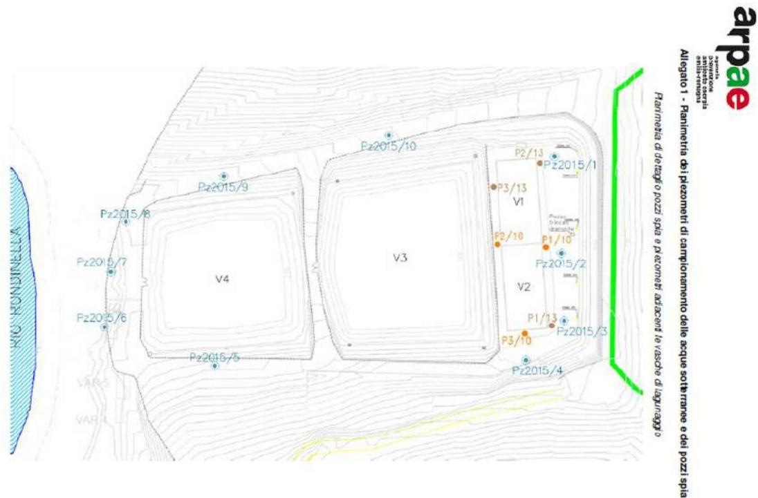
Figura 2: dettaglio dell'area delle vasche di raccolta del percolato (Fonte: comunicazione ARPAE Sinadoc 2089/2015 recante ad oggetto: conferenza dei servizi del 12/02/2016, trasmissione esiti analitici dei campioni effettuati da ARPAE a seguito di diffida ai sensi dell'art. 244 c.2 del D.Lgs. n. 152/2006 e s.m.i. presso la discarica di rifiuti non pericolosi "Tre Monti" situata nel Comune di Imola in via Pediano n.52).
