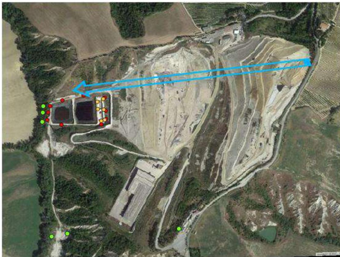
Figura 1: posizione dei piezometri, in giallo i cosiddetti "pozzi-spia" delle vasche di raccolta del percolato, in rosso i pozzi utilizzati per la caratterizzazione del fondo naturale delle acque sotterranee e in verde i cosiddetti "piezometri esterni".
